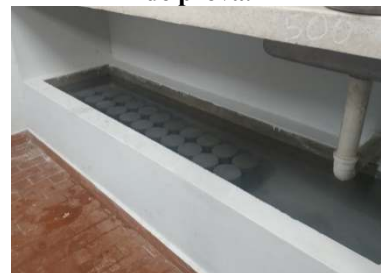
Figura 3.54 – Cura dos corpos de prova.
